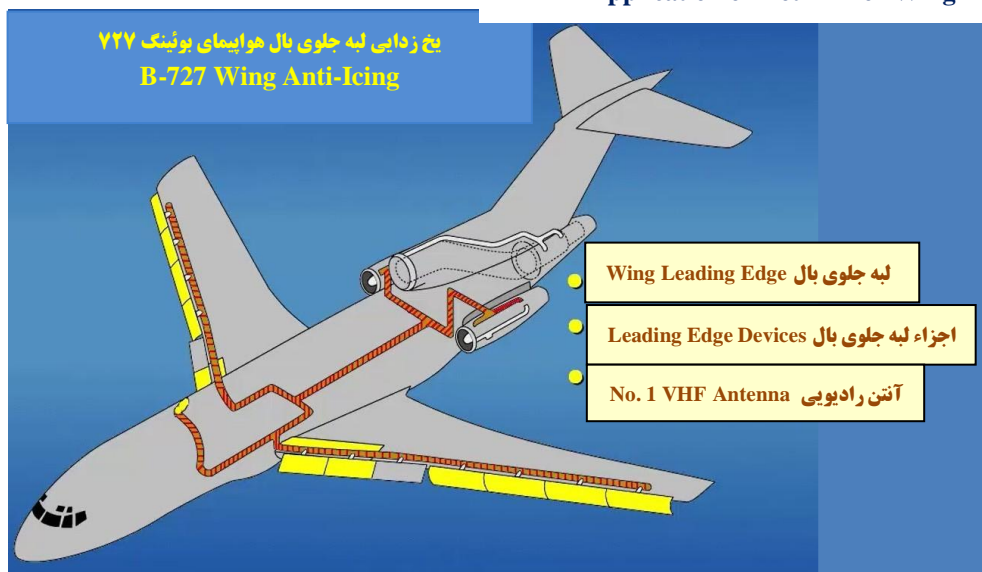
بکارگیری هوا گرم برای یخ زدایی لبه جلوی بالهای هواپیما Application of Hot Air for Wing Anti-Icing
