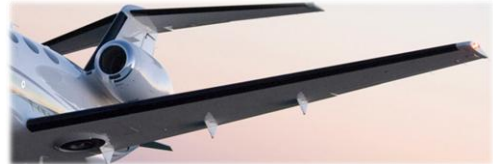
استفاده از بالشتک های لاستیکی هوا برای جلوگیری از یخ زدگی لبه جلوی سکانهای کنترل پرواز
