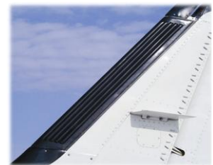
استفاده از بالشتک های لاستیکی هوا برای جلوگیری از یخ زدگی لبه جلوی سکانهای کنترل پرواز
