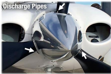
مجرای هدایت مایع ضد یخ بر روی تیغه ها Discharge Pipe
